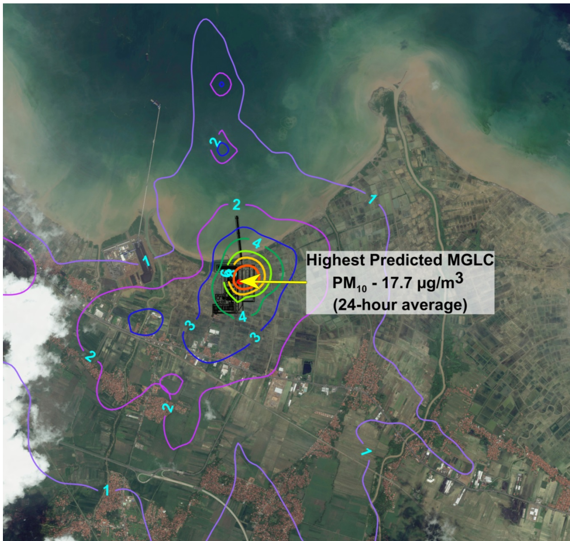
Gambar 3-29 Hasil pemodelan dispersi PM 10 (rata-rata 24 jam) dari seluruh sumber emisi yang dihasilkan oleh PLTU Cirebon kapasitas 1x1.000 MW (tidak termasuk background ).
