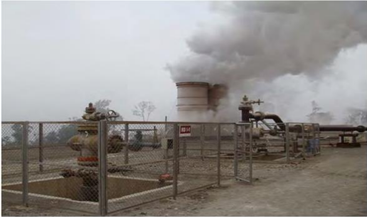
Gambar 2.22 Tipikal Pelepasan Uap ke Atmosfer saat Uji Alir Sumur melalui Cerobong AFT
