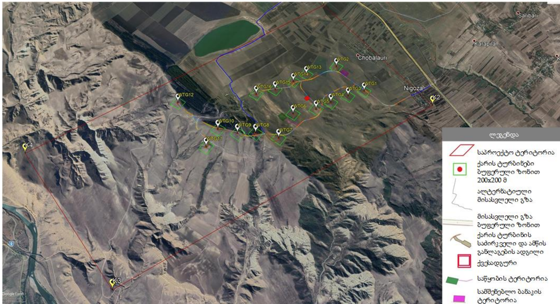
სურათი 4.1.1. ნიგოზას ქარის ელექტროსადგური გენერალური გეგმა
