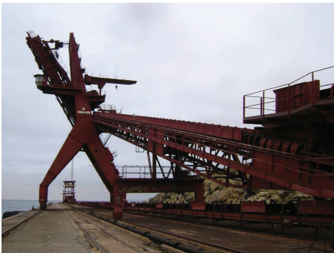
Fotografia 3.7 – Carregador de navios (shiploader) do Porto de Sacomar. O carregador será substituído
