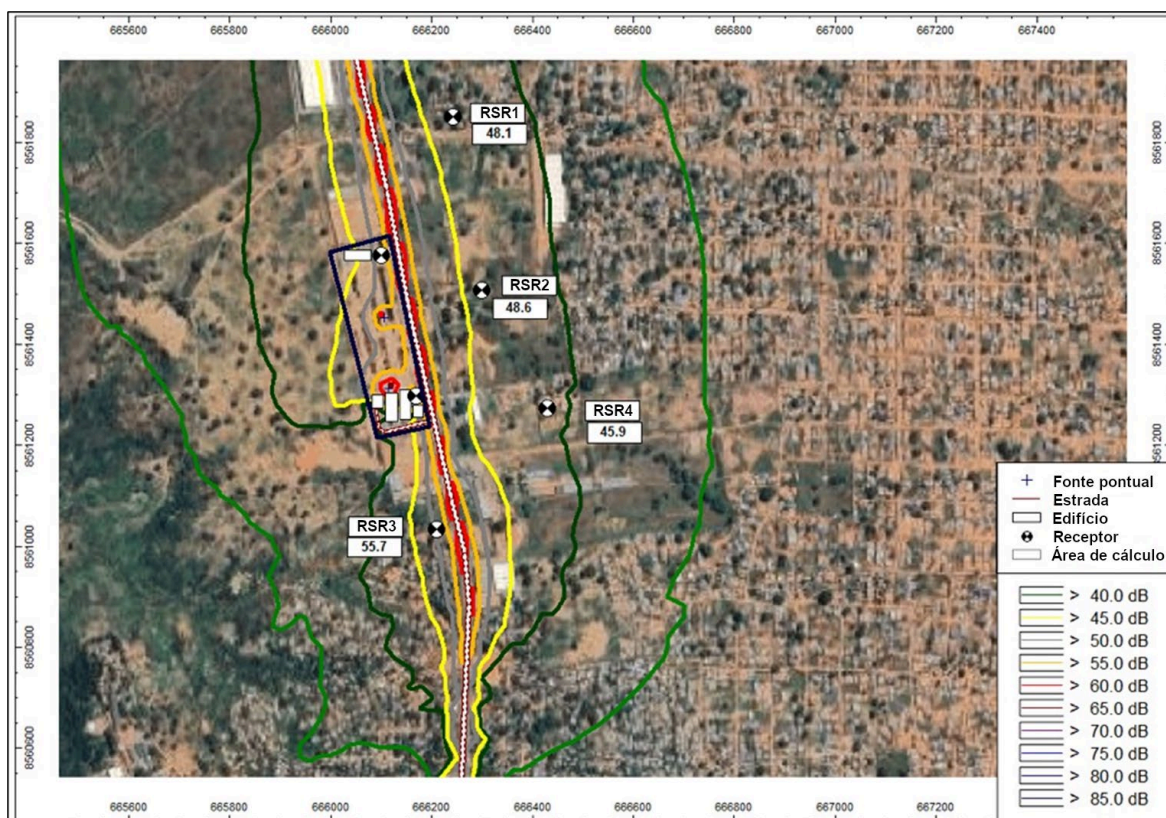
Figura 7.8: Níveis de ruído previstos nos RSR (Cenário SC3; fontes específicas do tráfego e do armazém)
