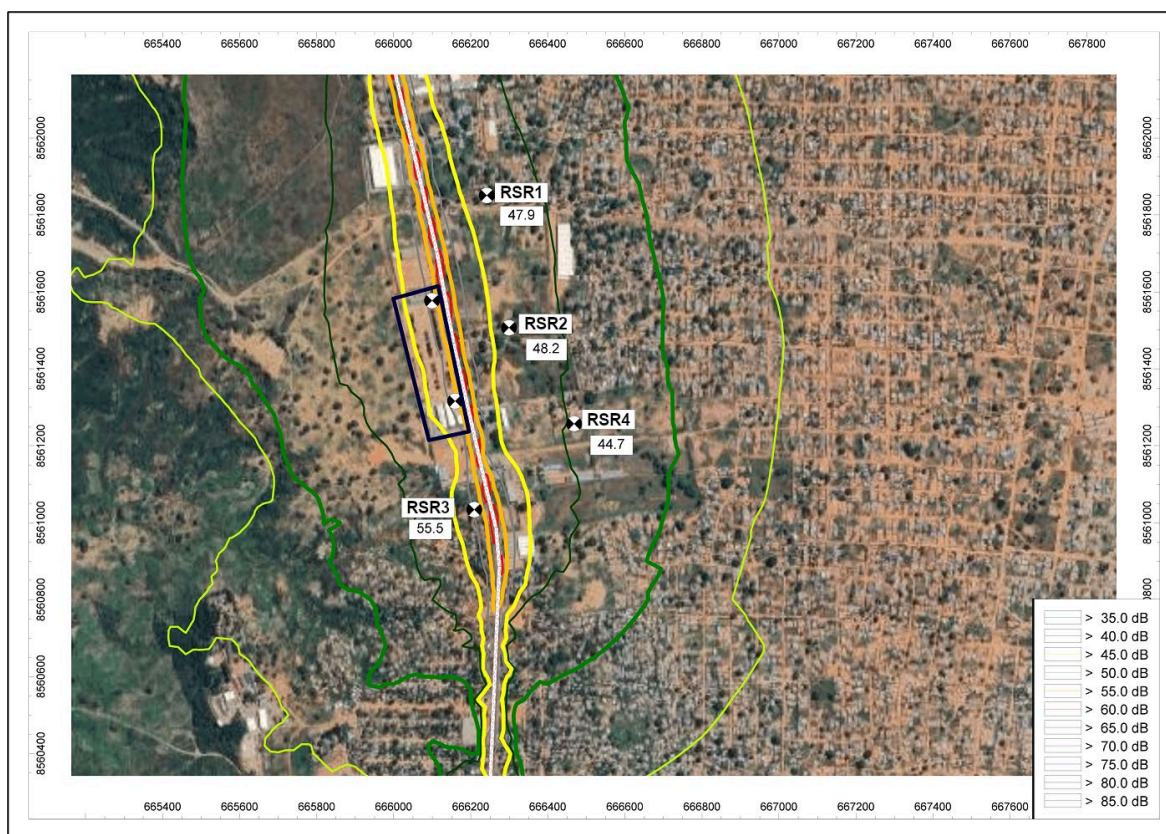
Figura 7.6: Níveis de ruído do tráfego previstos ao longo da rede rodoviária local (cenário da situação de referência SC1; tráfego existente)
